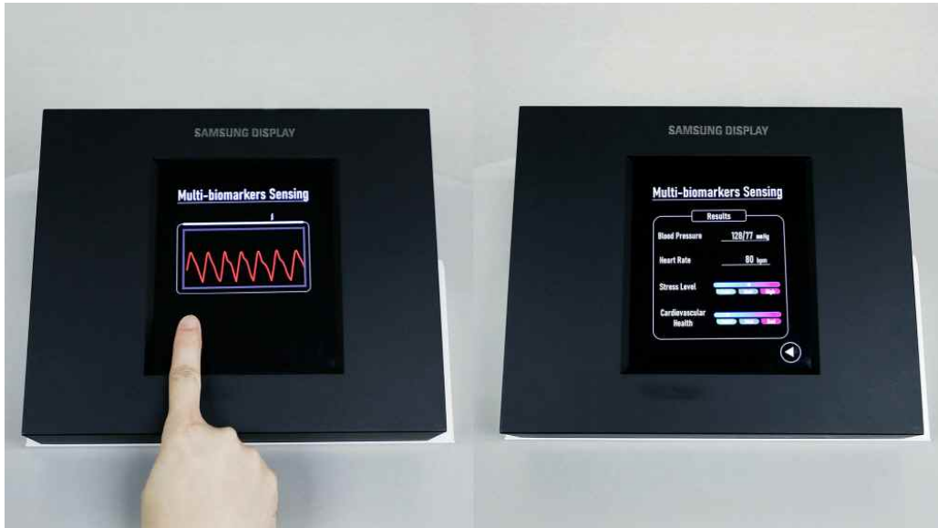
[그림 2] 삼성디스플레이가 공개한 센서 OLED 디스플레이
