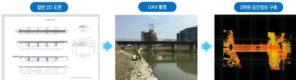
[그림 16] 무인항공기를 이용한 시설물(철도 교량)의 공간정보 구축 사례
